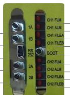
指示灯: CH1 FLAME 有火 指示灯: CH1 ALARM 报警
